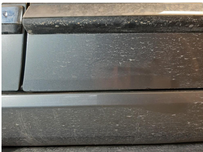
2.1 Steinsprut med rust
