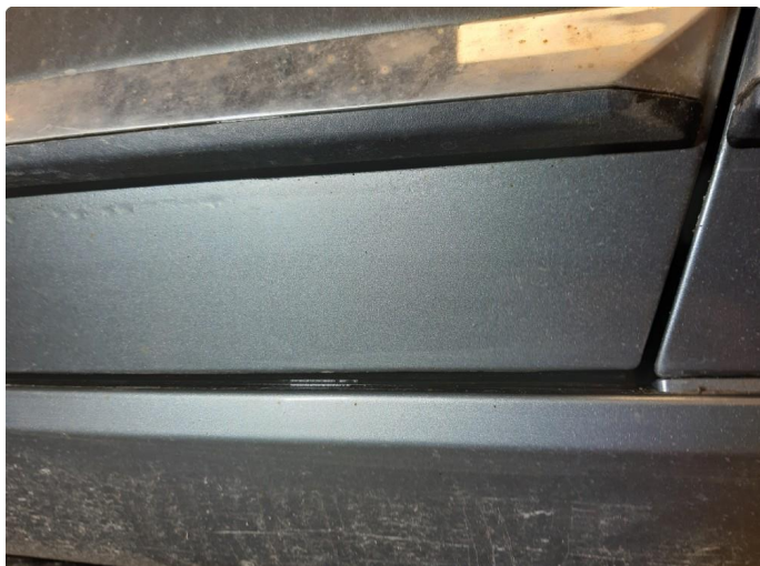
2.1 Steinsprut med rust
