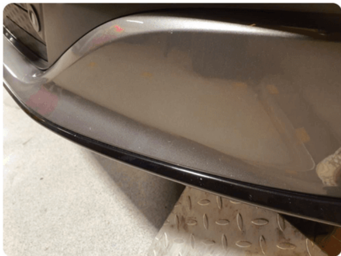
1.1 Øvrige feil Steinsprut i front
