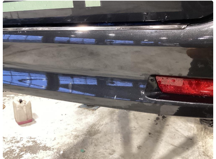
1.2 Ripe på støtfanger bak
