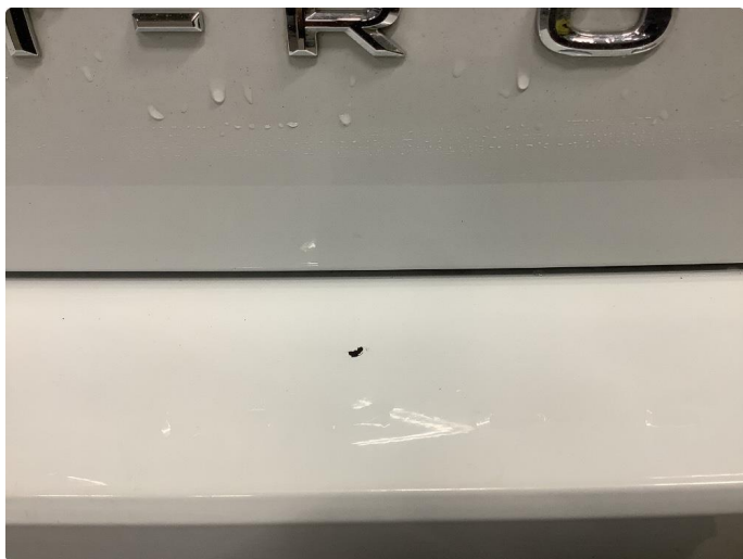
1.6 Liten lakkskade på støtfanger bak v/innlasting
