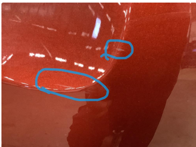
1.3 Små riper/skader ned til grunning
