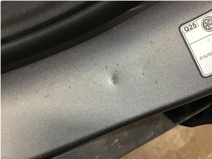
1.1 Bulk(er) med lakkskade
