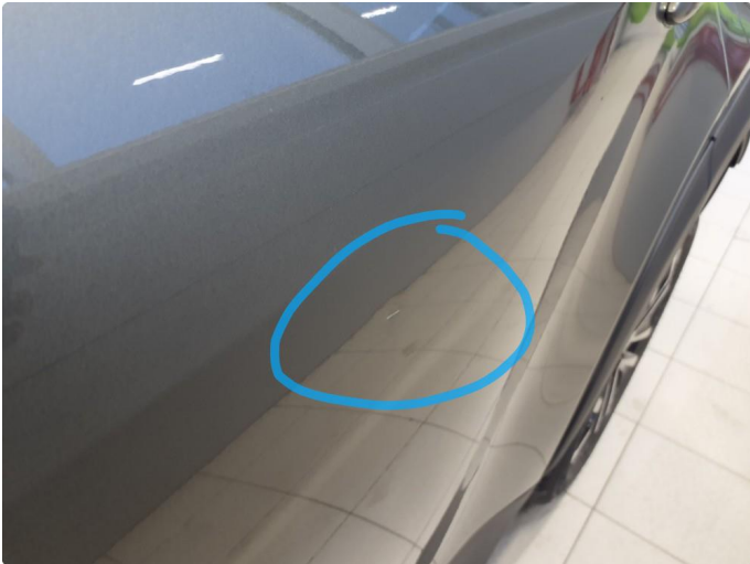
1.1 Liten parkeringsbulk med lakkskade
