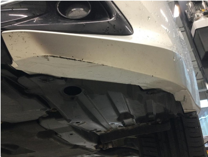
1.1 Noen skrubbskader underkant
