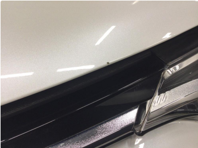
1.1 Noe steinsprut panser
