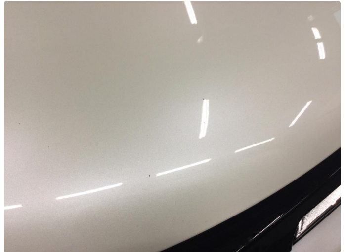
1.1 Noe steinsprut panser
