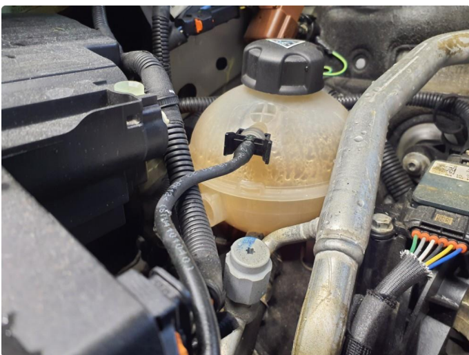
2.1 Kjøleveske under minimum
