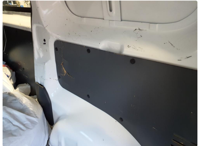
1.1 Noen bulker/riper innvendig varerom
