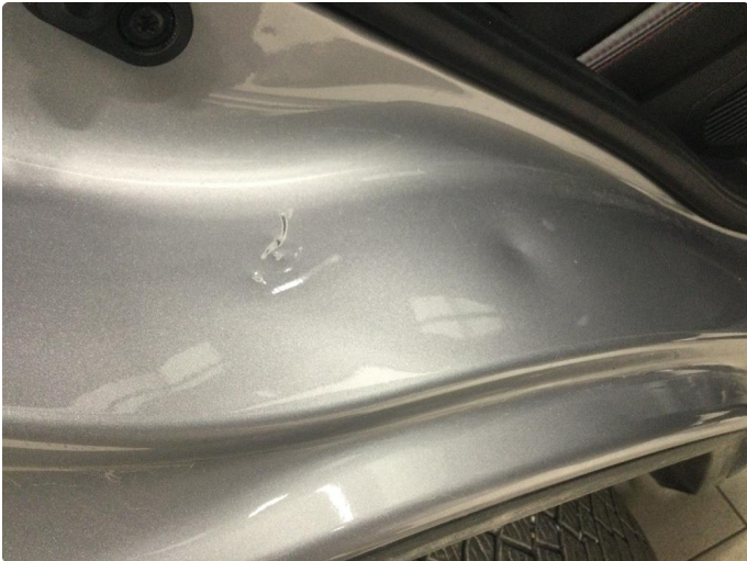
1.1 Liten bulk og lakkskade
