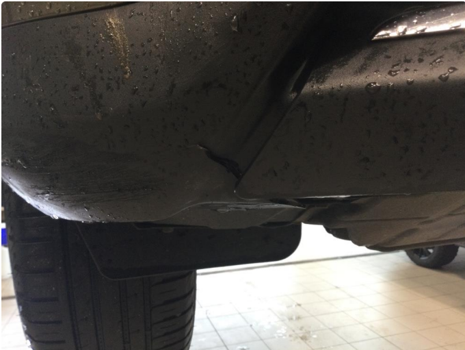
1.1 Ripe(r) ned til grunning
