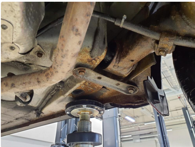
1.1 Noe overflaterust, bør vurdere en understellsbehandling
