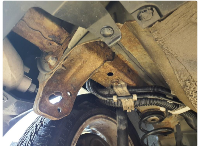
1.1 Noe overflaterust, bør vurdere en understellsbehandling
