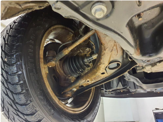
1.1 Noe overflaterust, bør vurdere en understellsbehandling
