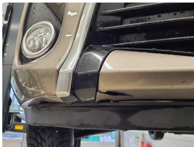
1.4 Liten sprekk, nedre del frontfanger
