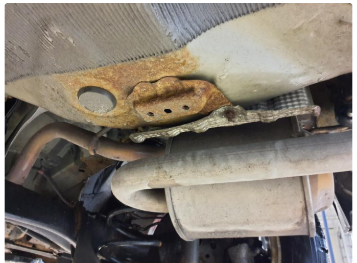
1.1 Noe overflaterust, bør vurdere en understellsbehandling
