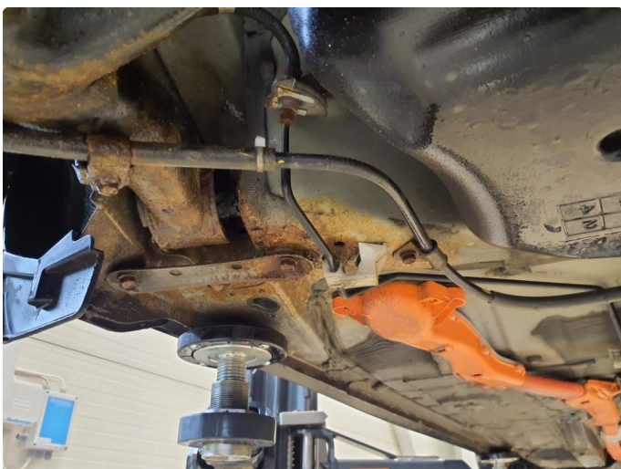
1.1 Noe overflaterust, bør vurdere en understellsbehandling
