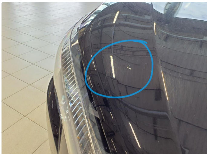
1.1 Litt steinsprut panser
