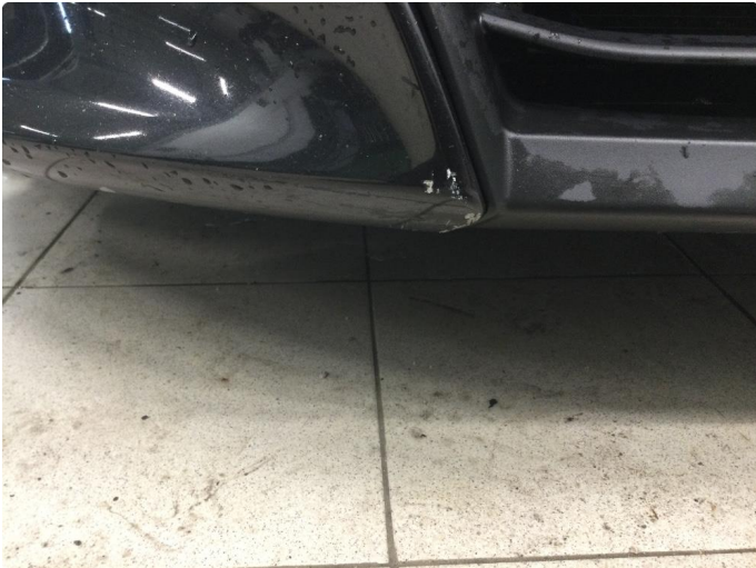
1.1 Noen lakkskader frontfanger
