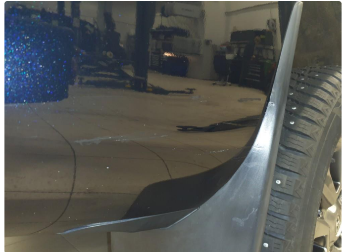
1.3 Noen små lakkskader frontfanger
