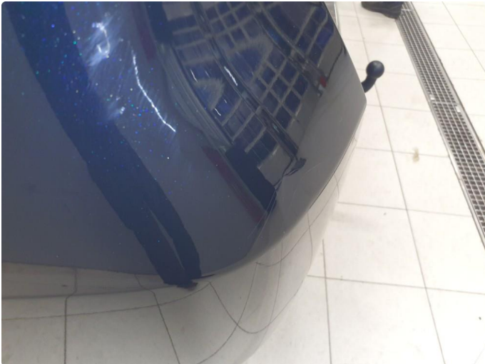
1.3 Noen små lakkskader frontfanger
