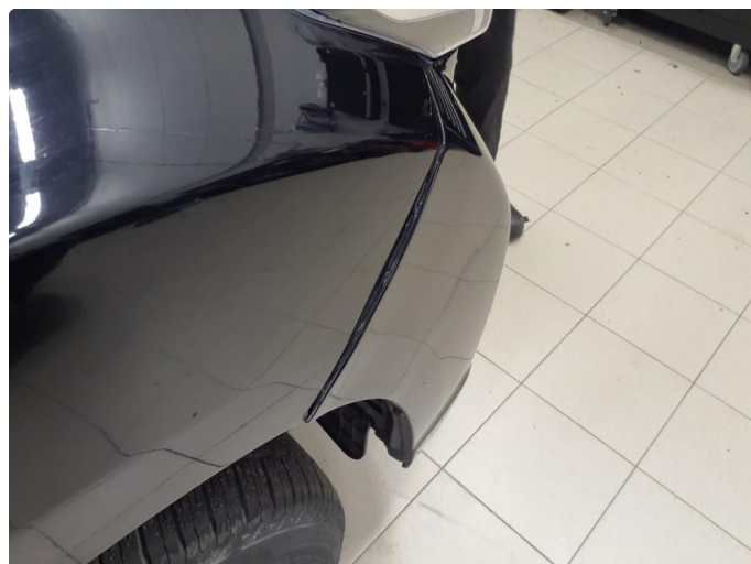
1.2 Noe avvik på innfestning
