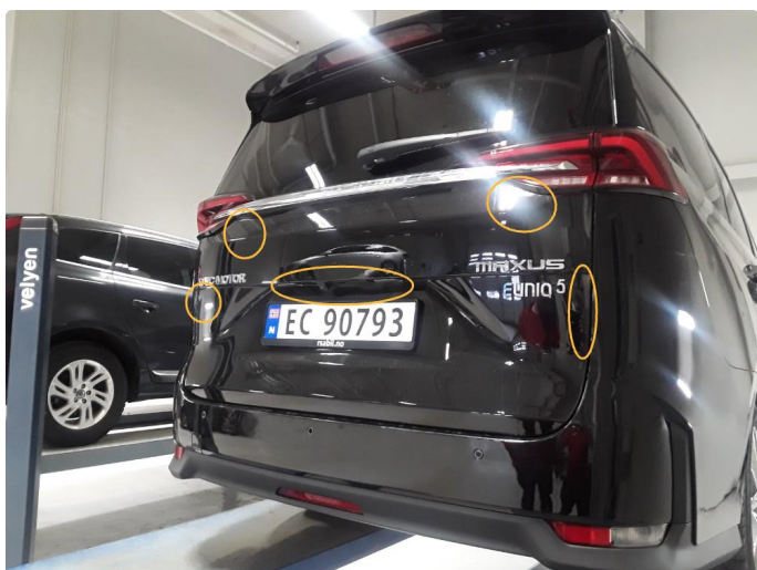
2.2 Stensprut/rust. Er flekket med lakkstift
