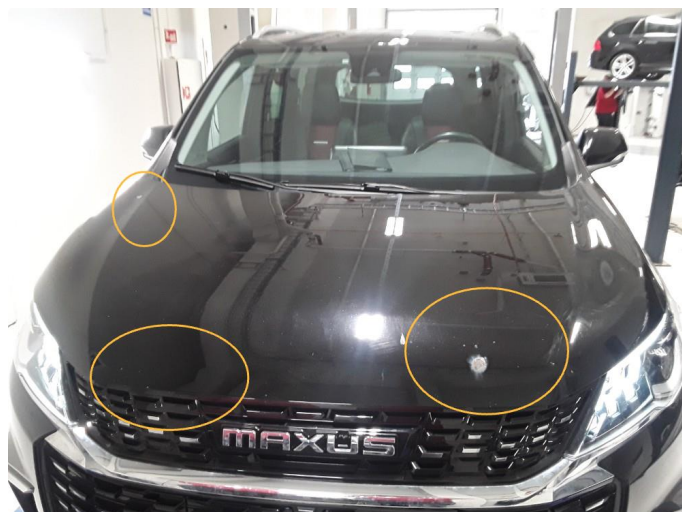
2.1 Stensprut/rust. Er flekket med lakkstift
