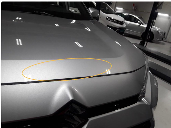
1.1 Steinsprut, er penslett med lakkstift
