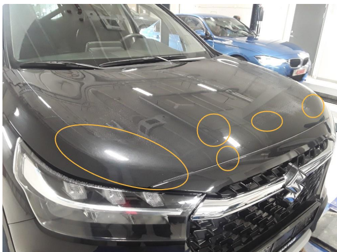
1.1 Steinsprut er penslet
