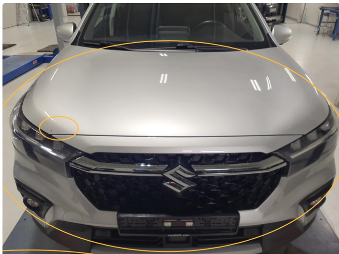
1.1 Steinsprut, er penslet med lakkstift
