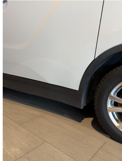
1.1 Merker venstre bakskjerm , Hengsler bakdører og dør h v side er flekket med lakk
