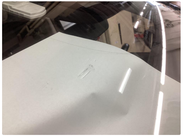
1.9 Steinsprut med sprekk utenfor synsfelt
