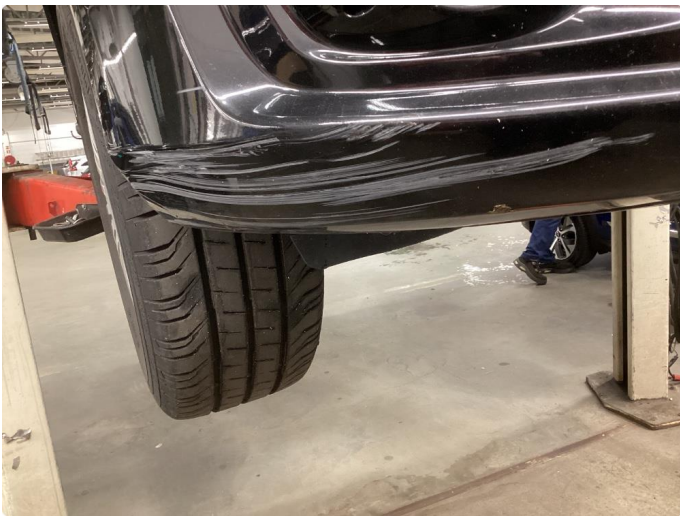
1.8 Ripe(r) ned til grunning
