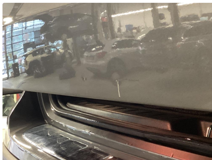
1.2 Liten bulk med lakkskade som er flekket
