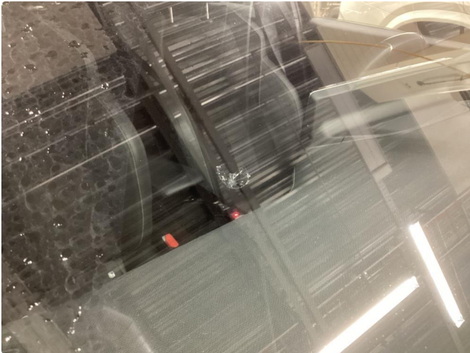
1.1 Steinsprut med sprekk utenfor synsfelt
