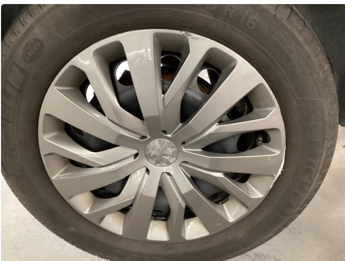
1.4 Hjul kapsel skadet
