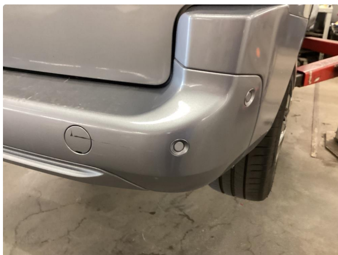
1.5 Ripe(r) ned til grunning
