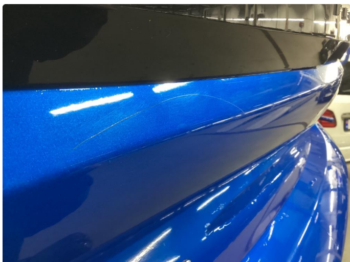
1.1 Lite synlig ripe som er polert
