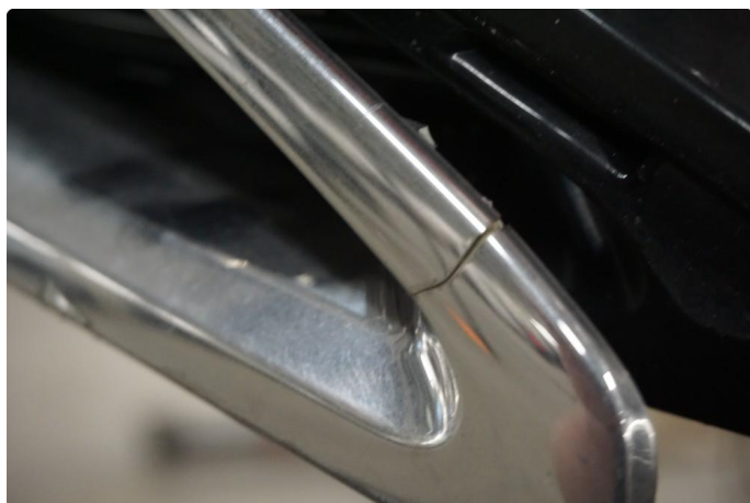
1.8 Riper/sprekk i deksel. Lite synlig.
