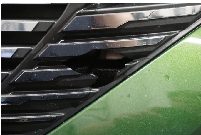
1.9 Liten sprekk/hull i grill
