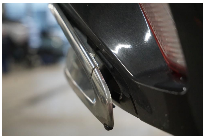
1.8 Riper/sprekk i deksel. Lite synlig.
