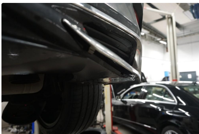
1.8 Riper/sprekk i deksel. Lite synlig.
