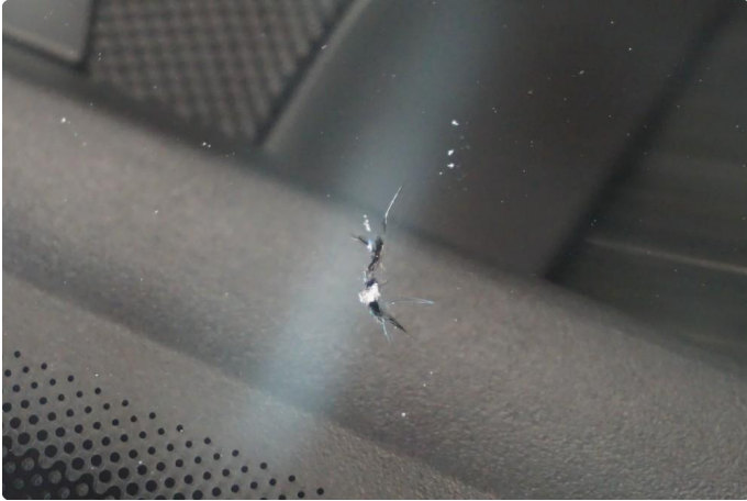
1.1 Steinsprut med sprekk
