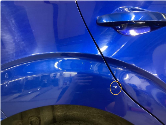
1.3 Ripe(r) ned til grunning
