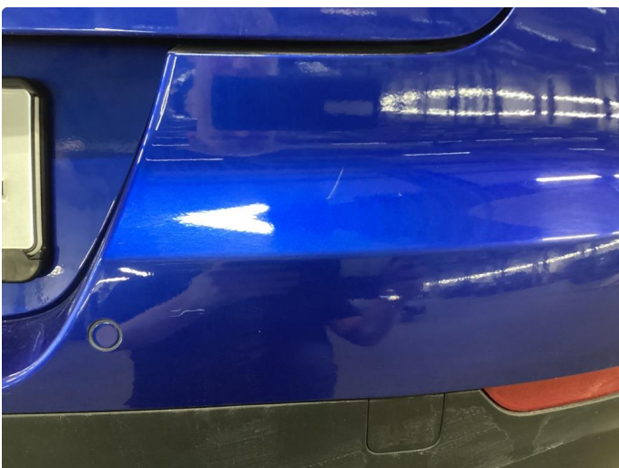
1.5 Ripe(r) ned til grunning
