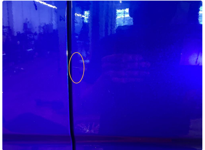
1.2 Ripe ned til grunning
