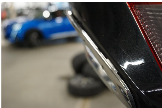
1.4 Liten sprekk i kromlist
