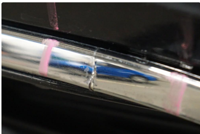
1.4 Liten sprekk i kromlist
