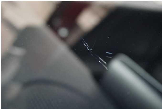
1.3 Steinsprut med sprekk (limt)
