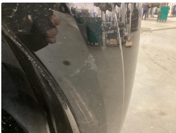
1.4 Ripe(r) ned til grunning
