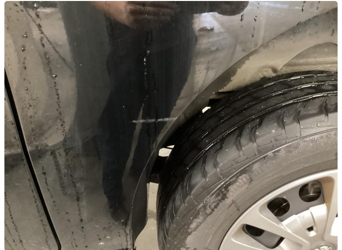
1.2 Ripe(r) ned til grunning
