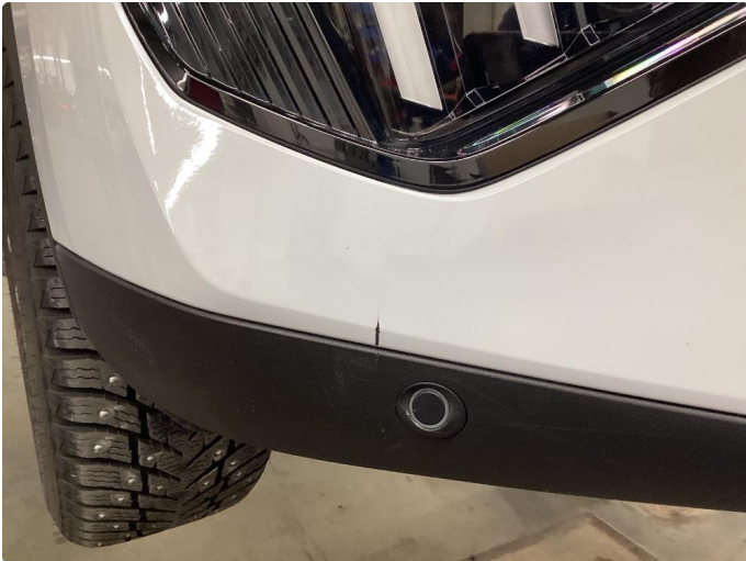
1.1 Ripe ned til grunning
