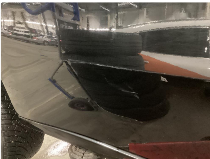
1.3 Ripe ned til grunning, polert
