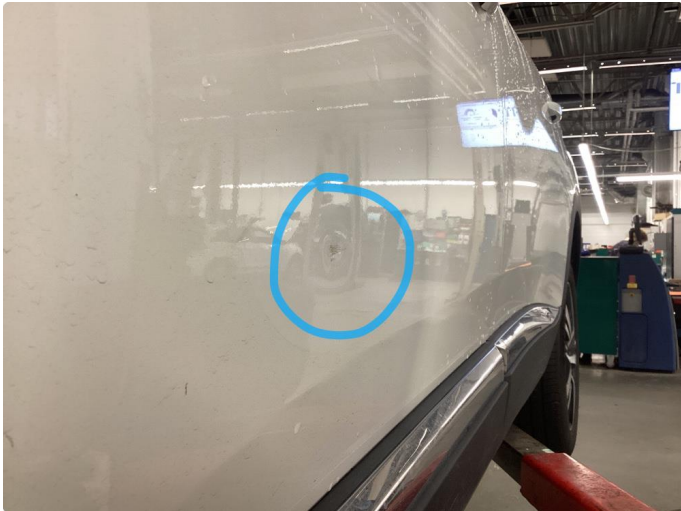
1.1 Liten bulk med lakkskade
