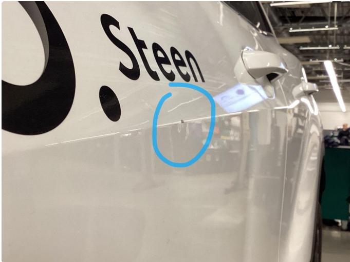
1.1 Liten bulk med lakkskade som er flekket
