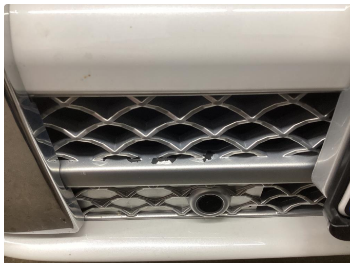
1.2 Litt lakk er borte
