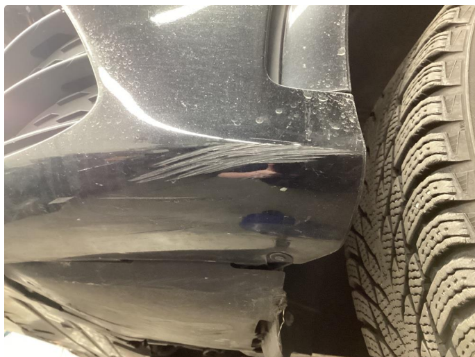
1.5 Skrubbskader underkant (polert etter bildet)
