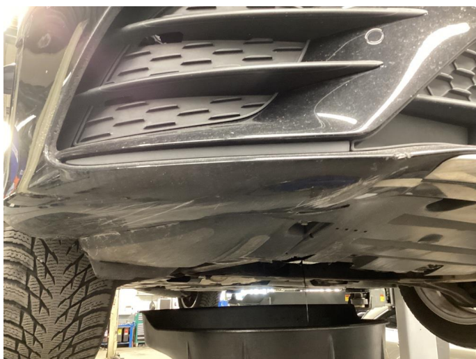
1.5 Skrubbskader underkant (polert etter bildet)
