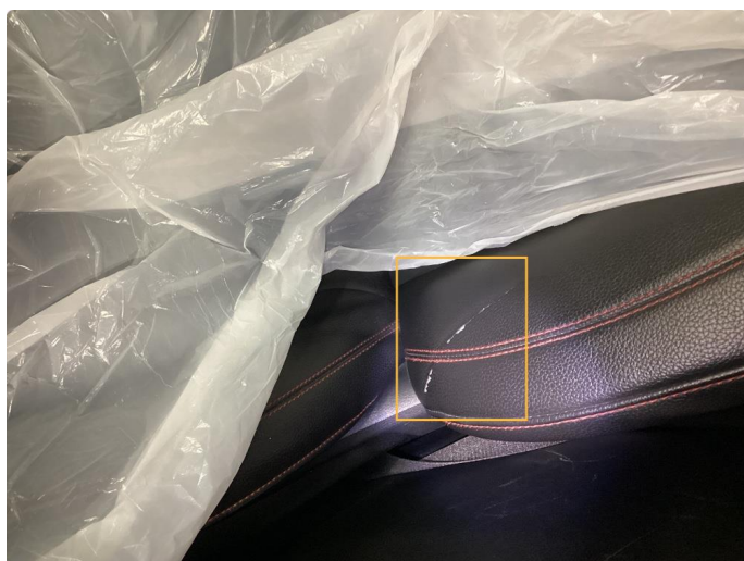
2.1 Skade på setetrekk
