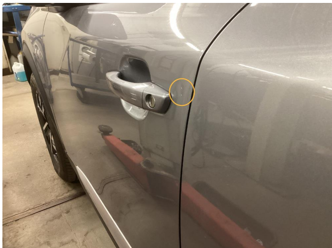
1.1 Liten bulk med lakkskade
