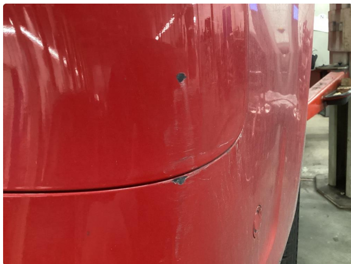
1.6 Merker i lakk som er flekket
