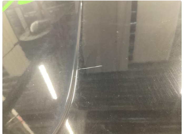
1.3 Ripe(r) ned til grunning
