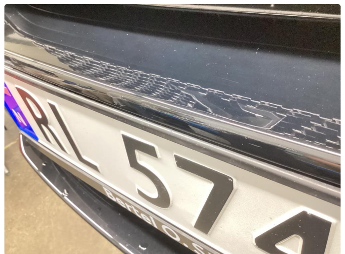
1.4 Ripe ned til grunning
