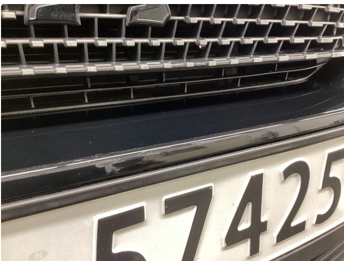
1.4 Ripe ned til grunning
