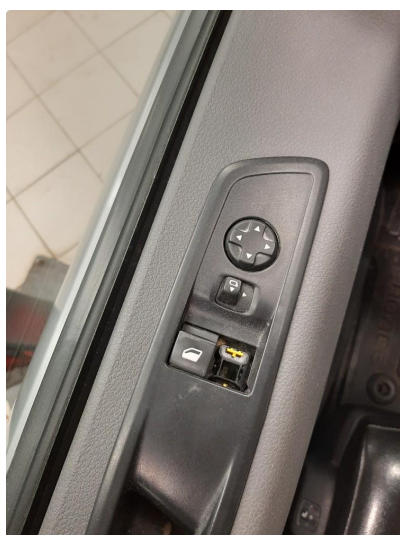
4.2 Vindusheis knapp på fører dør mangler
