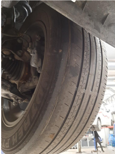
1.4 Dekk v.s foran er slitt ned til korden på innsiden. Må byttes.
