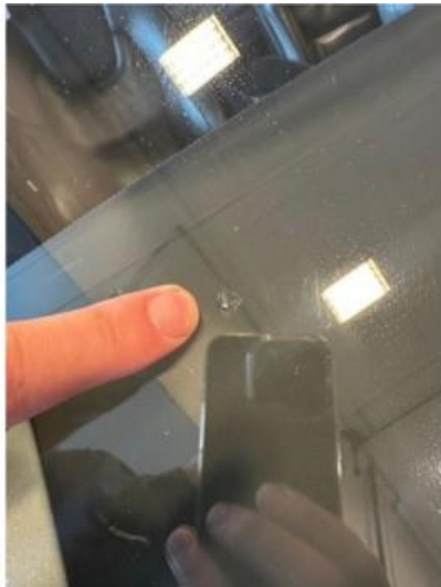
1.1 Reparert steinsprut i frontrute
