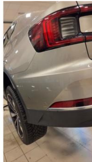
1.2 Liten lakkskade på venstre side av støtfanger bak, flekkes
